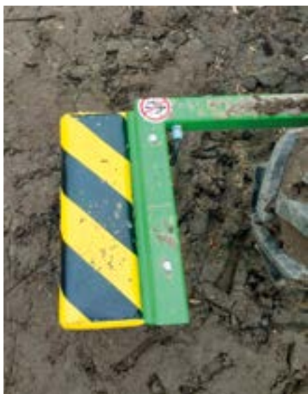
Ostatecznym zabezpieczeniem przed kolizją są czujniki zderzeniowe.
