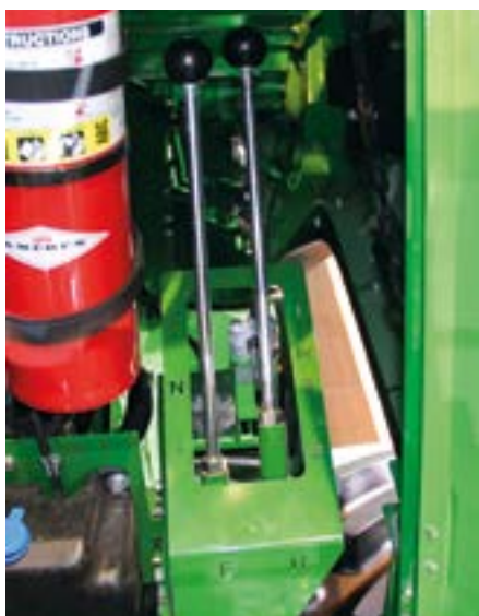
Lewa dźwignia służy do zmiany prędkości bębna rozdzielającego masę na dwa rotory. W kukurydzy pracujemy na pierwszym, wolniejszym przełożeniu.
