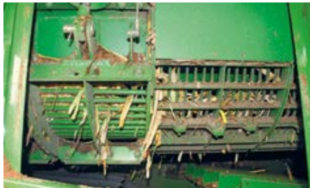
Do kukurydzy klepiska w sekcji młócenia rotorów wymieniamy, a w strefie separacji opuszczamy przy pomocy tulei dystansowych.
