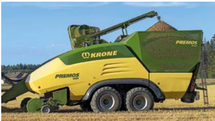
Maszyna przyczepiana Krone Premos 5000 została zbudowana do produkcji peletu na polu bezpośrednio z pokosów słomy pozostawionej za kombajnem.
