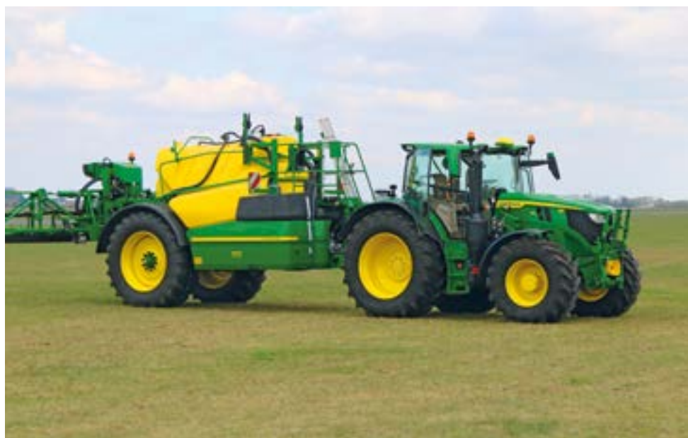
Opryskiwacz John Deere R975i jest największym modelem przyczepianym tego producenta. Jak wskazuje nazwa zbiornik główny ma pojemność 7500 l.
