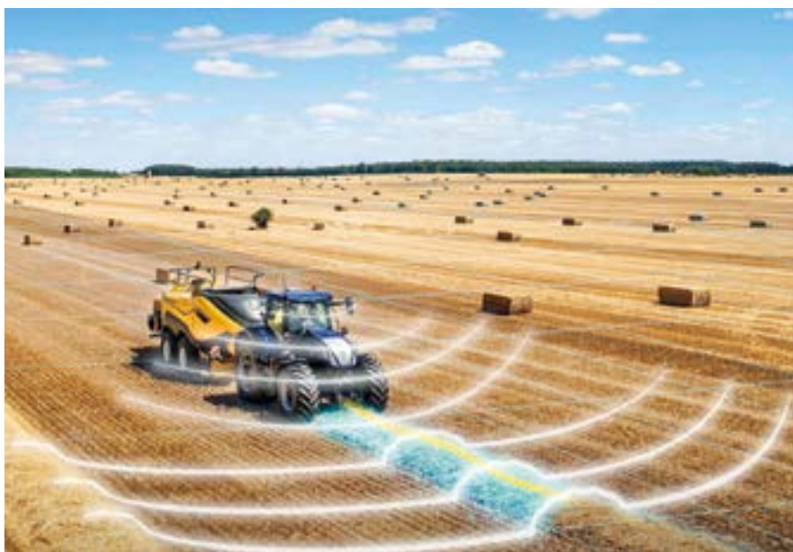
Skaner Lidar zamontowany na przedniej części dachu traktora mierzy pokos przed ciągnikiem za pomocą lasera, a zintegrowany z nim czujnik IMU wykrywa przyspieszenie i orientację ciągnika.
