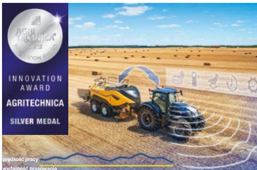
Big Baler Automation nadzoruje m.in. automatyczne prowadzenie ciągnika nad pokosem oraz prędkość pracy, która dopasowywana jest do wielkości masy roślinnej.
