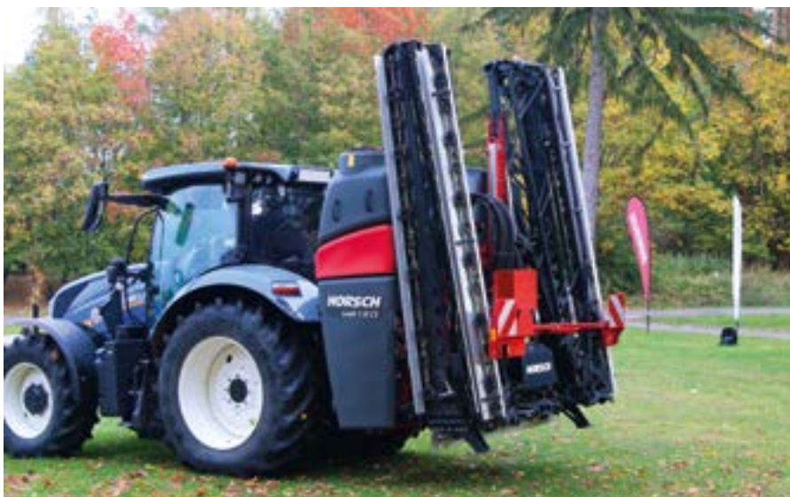
Opryskiwacze Horsch Leeb serii CS zawieszane na tylnym TUZ ciągnika oferowane są ze zbiornikami na ciecz roboczą o pojemnościach: 1400, 1800 i 2200 l.
