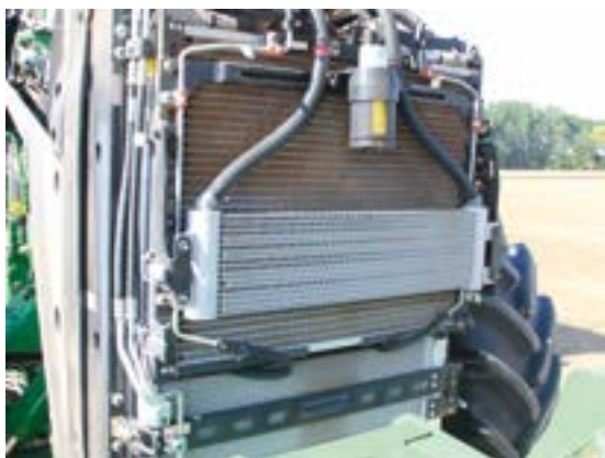
Znakiem rozpoznawczym ciągnika 8R z przekładnią eAutoPowr jest dodatkowa chłodnica do odbioru ciepła z prądnicy i silnika elektrycznego.
