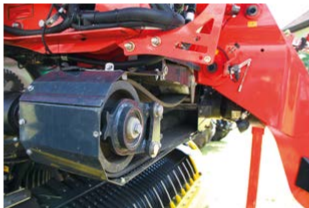
Jedną z cech nowych maszyn do zwózki zielonki, jest nowa linia napędowa. Napęd z ciągnika odbywa się poprzez wał przegubowo-teleskopowy, a następnie poprzez przekładnię z wielorolkowym pasem. Jest on zdolny do przenoszenia momentu obrotowego w każdych warunkach pracy maszyny.
