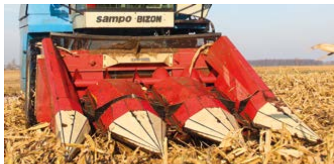
Trzyczędowna przystawka do kukurydzy to niecodzienny widok. Włoska firma Fantini, jako jedna z nielicznych, do dzisiaj produkuje adaptery w tak małym rozmiarze.
