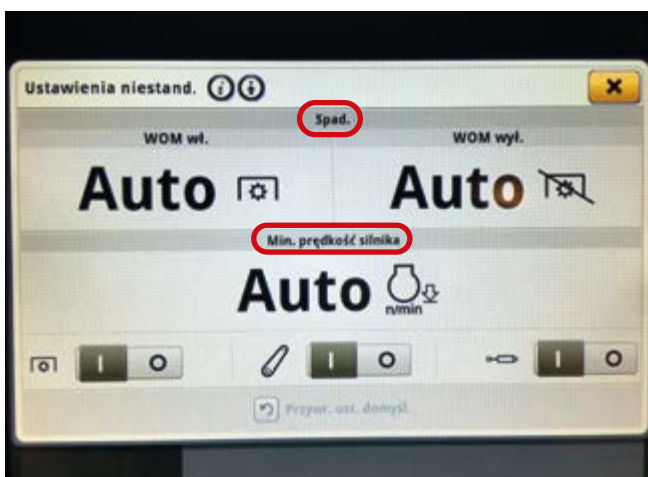
W celu aktywacji trybu niestandardowego przekładni AutoPowr należy w terminalu ciągnika John Deere otworzyć okno jej ustawień i wybrać ikonę oznaczoną jako tryb niestandardowy (z napisem „Niestand.”).
