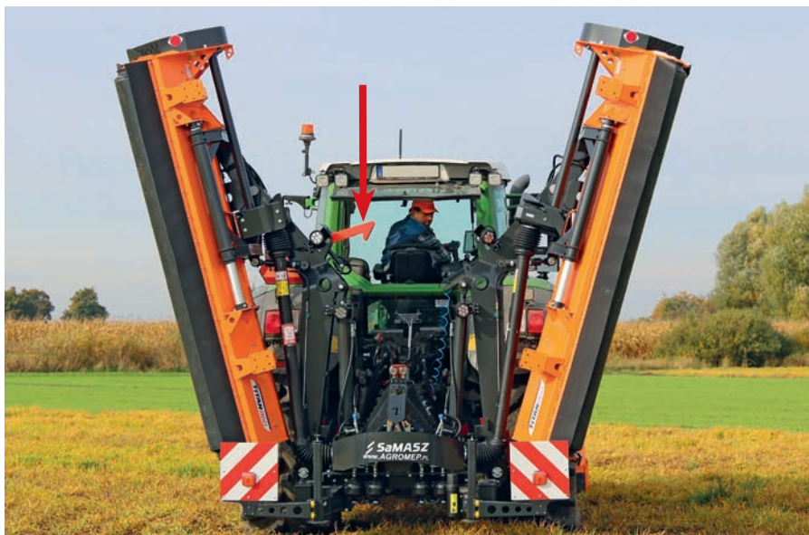
Zabezpieczenie zwalniane hydraulicznie pozwala szybko rozłożyć kosiarki bijakowe tylne Titan 860 do pozycji roboczej.
