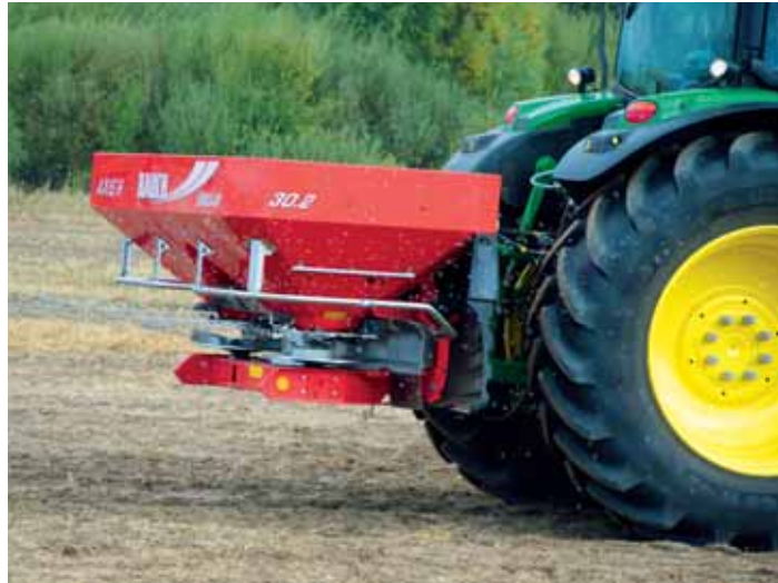
Rozsiewacz Rauch Axis H 30.2 EMC+W podczas rozsiewu w systemie zmiennego dawkowania.
