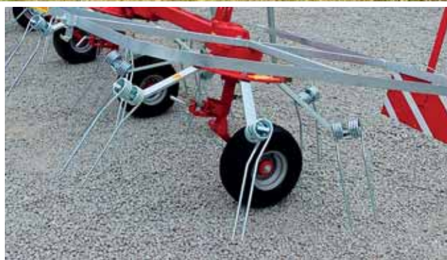
Średnice gwiazd wahają się od 1,25 m w maszynie marki Jar-Met (u dołu) do 1,80 m w niektórych modelach z logo Kuhn.
