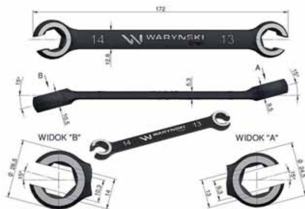
Klucze marki Waryński Origin przedstawione w tym artykule (oprócz typu Torx i Hex) spełniają wymagania normy amerykańskiej ASME B107.100.
