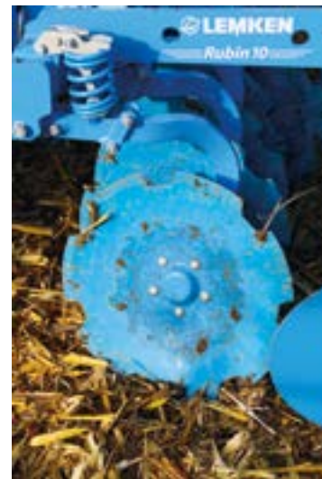
W nowych narzędziach Lemken zastosował większe talerze o średnicy 645 mm i zwiększył średnice piast elementów roboczych.
