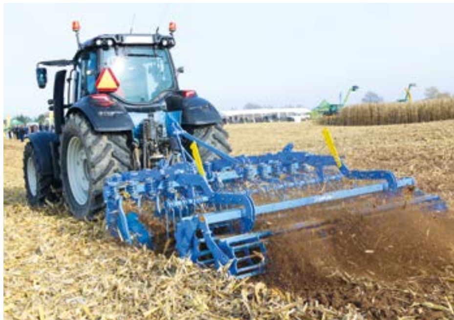
Jednym z mniejszych przedstawicieli nowego typoszeregu zawieszanych bron talerzowych Rubin 10 jest Rubin 10/300U o sztywnej ramie i szerokości roboczej 3 m.
