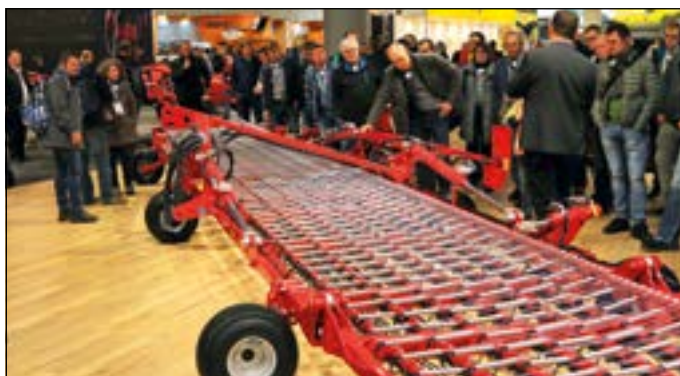
Brona-zgrzebło Horsch Cura ST do mechanicznego zwalczania chwastów i stacja dokująca John Deere dla autonomicznych dronów, które najpierw skanują pole, a potem opryskują tylko miejsca tego wymagające. Wbrew pozorom to nie kontrasty, ale uzupełniające się technologie.
