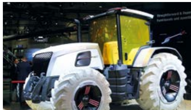
Ciągnik koncepcyjny marki Massey Ferguson, w którym zamiast kierownicy zamontowano dżojstik, a w miejscu lusterek bocznych kamery multispektralne skanujące otoczenie.
