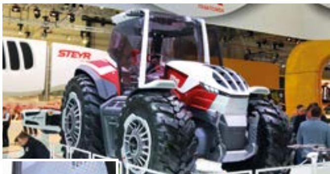
Ciągnik koncepcyjny marki Steyr z napędem hybrydowym spalinowo-elektrycznym. Zamiast kierownicy zaproponowano drążek przypominający wolant samolotu.
