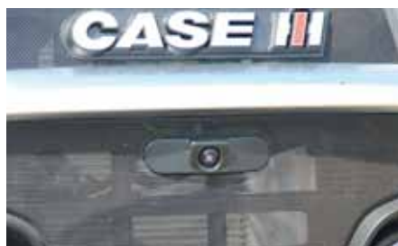
Kamera zamontowana na przodzie maski pokrywy silnika przekazuje obraz na nowy terminal pokładowy AFS Pro 1200 i stanowi standardowe wyposażenie.
