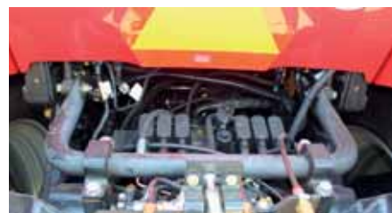
Widoczny nad blokiem zaworowym poprzeczny stabilizator to element nowego systemu półaktywnej amortyzacji kabiny.
