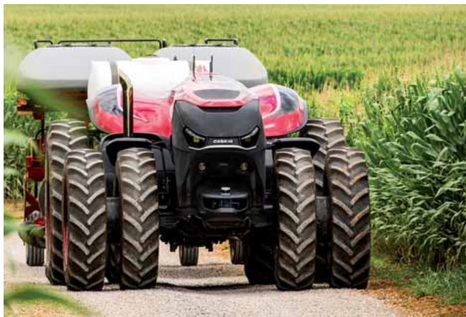
Case IH ACV nie ma kabiny, co powoduje, że wygląda jak robot ciągnik.
