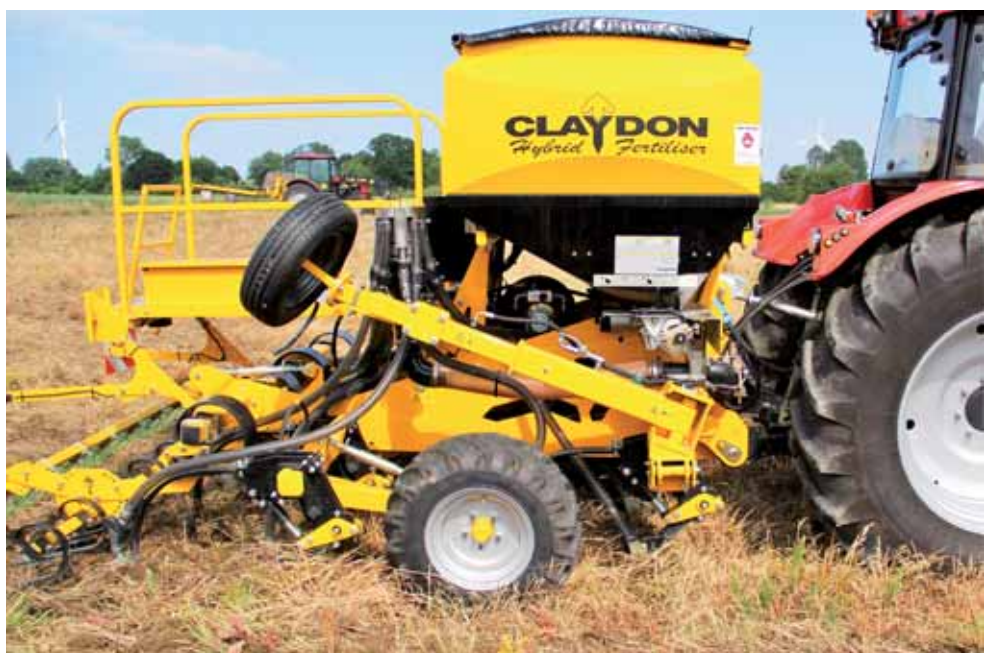
Zęby uprawowo-nawozowe i montowane z nimi poprzez jedną obejmę redlice nasienne rozstawione są w dwóch rzędach, co zmniejsza ryzyko ich zapchania się resztkami po-
