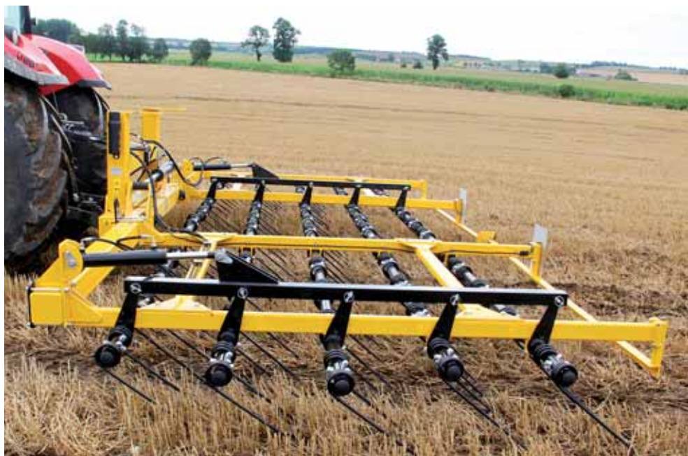
Brony Claydon wżruszają ściernisko i rozgarniają słomę przez solidne sprężynowe palce ułożone w pięciu rzędach.
