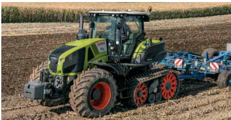
Claas Axion 900 Terra Trac to pierwszy ciągnik półgąsienicowy z pełnym zawieszaniem.
