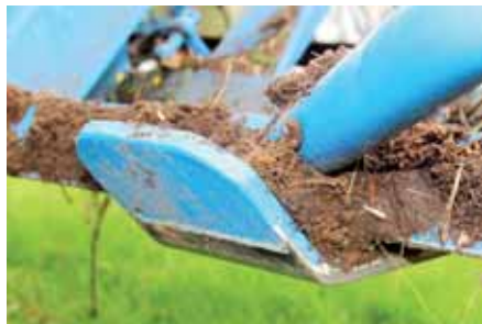
Cztery płozy w przedniej części agregatu skutecznie zapobiegają spychaniu gleby.
