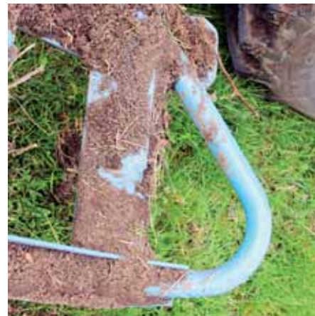
Solidne zagięte rurki chronią ramę Hybro przed uderzeniami przeszkód oraz ich wleczeniem.
