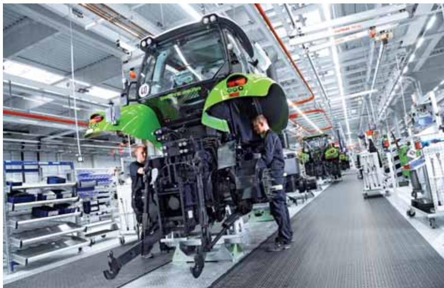
Nowy obiekt w Lauingen może pochwalić się pierwszą na świecie linią montażową otoczoną ruchomą i amortyzowaną podłogą dla pracowników.
