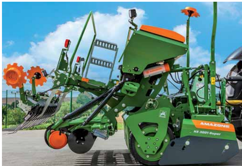
Siewnik Cataya 3000 Special nabudowany na bronie aktywnej Amazone ma zbiornik o pojemności 650 l, który po zamontowaniu nadstawek można powiększyć do 850 l.
