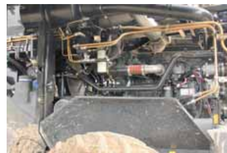
Silnik FPT Cursor o pojemności 12,9 l i mocy maksymalnej 544 KM nie ma filtra cząstek stałych i EGR-u.
