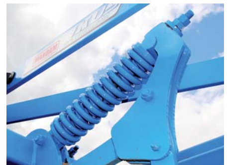
Testowany KUS wyposażony był w podwójne zabezpieczenie sprężynowe zębów.
