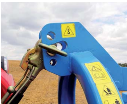
Przy obu ciągnikach górny łącznik podpięliśmy do fasolkowego otworu kozła zawieszania agregatu.
