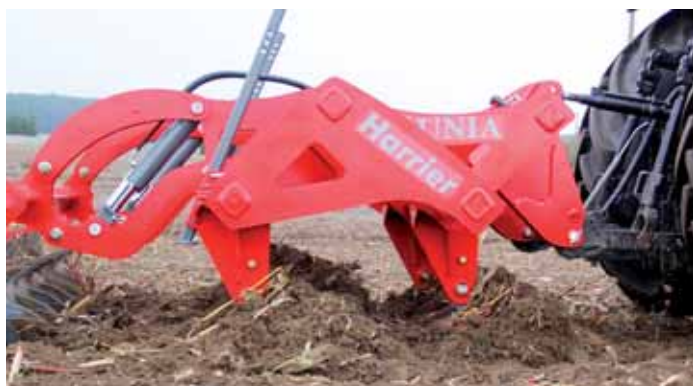
Pług dłutowy Harrier, zarówno w wersji trzy-, jak i czterometrowej ma rozstaw pomiędzy belkami z zębami wynoszący 100 cm. Prześwit pod ramą to aż 90 cm.
