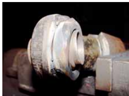
Fot. 2. Po usunięciu części oczka na ramieniu podnośnika dospawano połówkę nakrętki M36 po usunięciu gwintu i wybraniu materiału na kulę.
