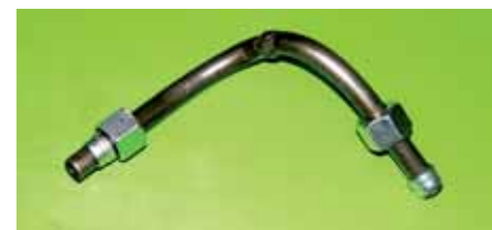
Fot. 4. Złączka wykonana została z rurki stalowej ciągnionej o wymiarze 12 x 2. Na jej końce założono opaski klinowe i nakrętki zaciskowe M18x1,5. Spawane połączenie wytrzymało z potrzeby skręcenia rurki o 90°.
