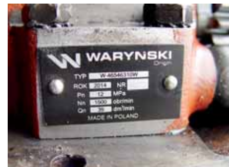
Fot. 3. Wydatek nowej pompy (39 l/min) odnosi się do obrotów 1500 na minutę. W praktyce w ciągniku osiąga ona 1260 obr./min, co daje wydatek 33 l/min przy obrotach nominalnych silnika.
