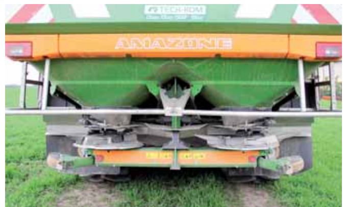
Rozsiewacz Amazone Profis Hydro ma hydrauliczny napęd tarcz oraz elektryczne zamykanie zasuw.
