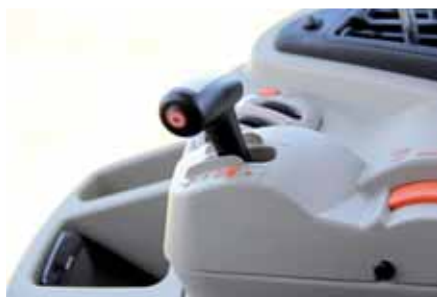
W przekładniach Dyna-4 i Dyna-6 biegi zmieniamy takim samym lewarkiem.
