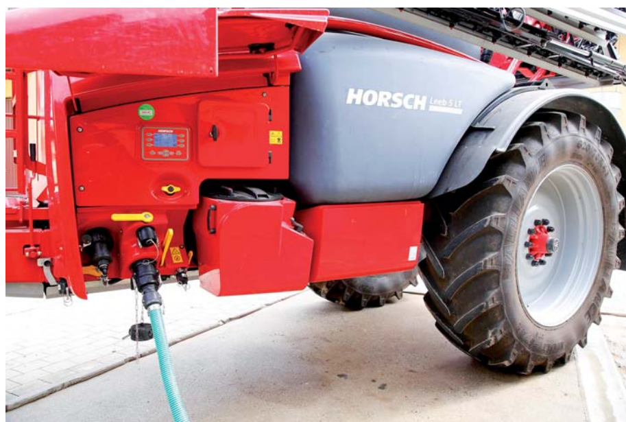
W zależności od pakietu wyposażenia maszyna może zawierać sterowanie ręczne lub elektroniczne zaworami ułożonymi po stronie ssawnej, jak i tłocznej pompy.
