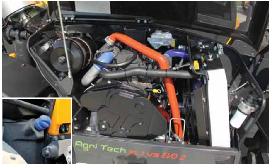
Pod maską ładowarki pracuje czterocylindrowy silnik FPT o mocy maksymalnej 141 KM i systemem neutralizacji spalin SCR. Zbiornik AdBlue o pojemności 27 l umieszczony jest z tyłu maszyny.
