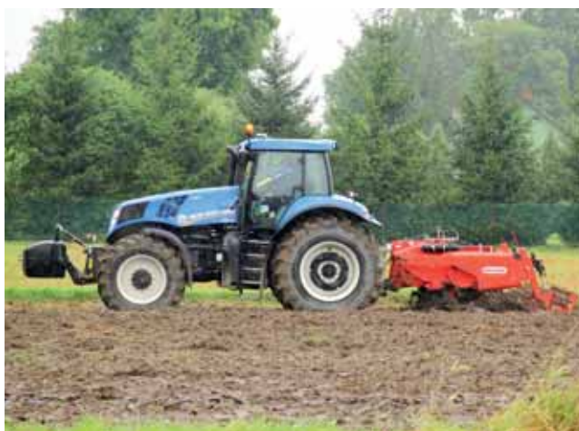
W ciągnikach New Holland IntelliSteer Ready wystarczy zamontować sterownik nawigacyjny i odbiornik sygnałów z satelitów, aby pracować w systemie jazdy automatycznej EGNOS (+/- 20 cm). Pozostałe poziomy dokładności wymagają odblokowania odbiornika lub subskrypcji sygnału.
