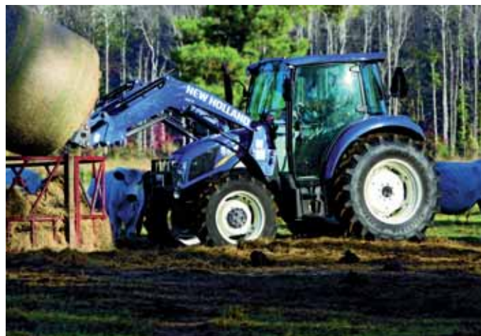
Prawie identyczna moc uzyskiwana przez te ciągniki z trzech i czterech cylindrów nie ma wpływu na czasookresy przeglądów – są identyczne.
