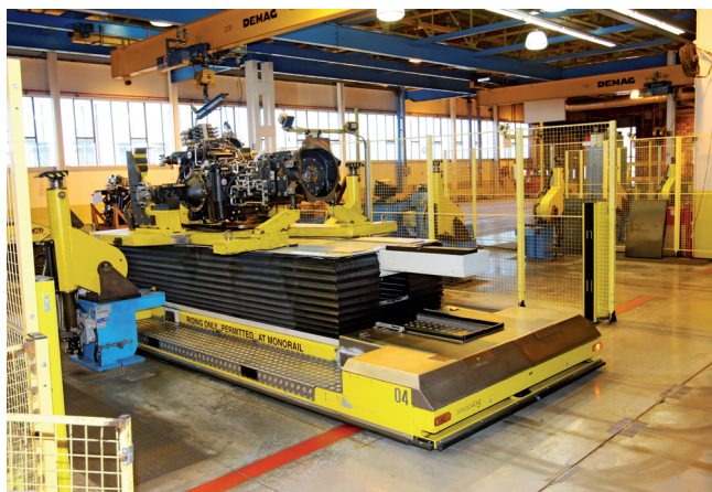
Pojazdy AGV (Auto Guided Vehicle) bez udziału ludzi przewożą silniki oraz przekładnie napędowe do miejsc montażu.
