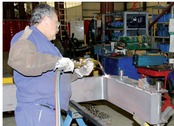
Spawy są wygrzewane w celu ich wzmocnienia.
