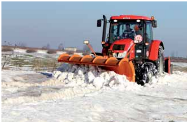
Zetor Forterra 120 zimą doposażany jest w pług odśnieżny i wirnikowy, a jesienią ciągnie pług obracalny. Jest to więc ciągnik do trzech pługów.
