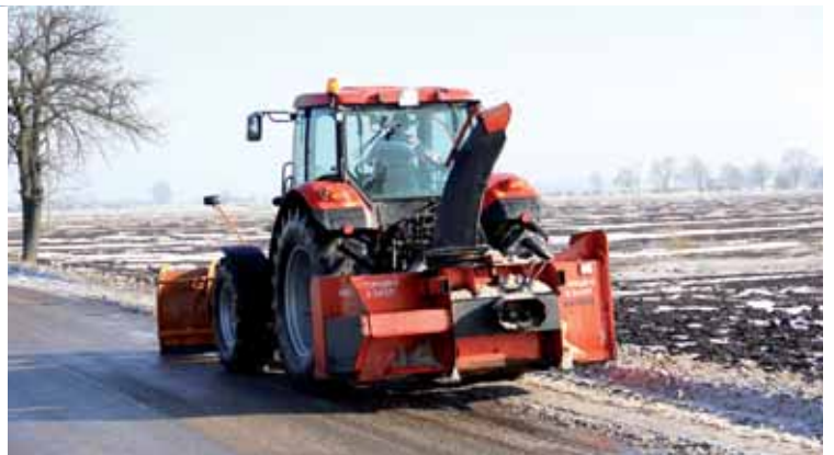
Zetor Forterra 120 zimą doposażany jest w pług odśnieżny i wirnikowy, a jesienią ciągnie pług obracalny. Jest to więc ciągnik do trzech pługów.
