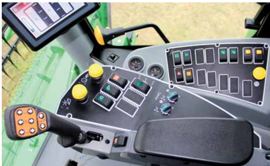
Ważniejsze – zdaniem producenta – funkcje obsługiwane są za pomocą dżojstika i na podłokietniku, zaś rzadziej wykorzystywane przełączniki znajdują się nieco dalej na pulpicie.
