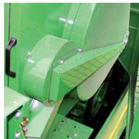
W pobliżu pakietu chłodnic znajdziemy rotacyjną osłonę przeciwpyłową w towarzystwie turbiny odciągającej zanieczyszczenia z powierzchni czołowej obrotowego kosza filtrującego zaciągane przez wentylator powietrze.
