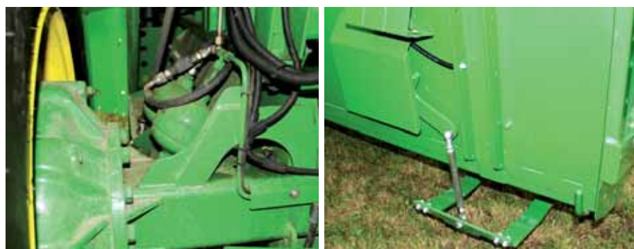
Dwie „gruszki” azotowe przy przedniej osi kombajnu odpowiadają za odciążanie zespołu żniwnego, zaś płozowe czujniki oporowe za jego dostosowywanie się do ukształtowania terenu.
