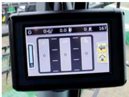
Na kolorowym ekranie terminala pokładowego możemy m.in. monitorować w postaci czytelnych słupków poziom strat ziarna na sitach i wytrząsaczu oraz przepływ niedomłóconych kłosów.
