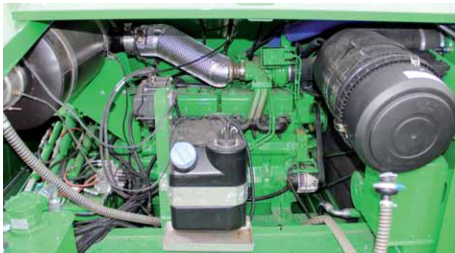
Umieszczony tradycyjnie za zbiornikiem ziarna silnik o mocy nominalnej 238 KM spełnia wymagania normy Euro IV. To pierwszy kombajn marki John Deere z zainstalowanym systemem SCR.
