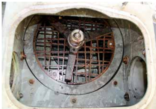
Sercem systemu MeyloCut jest wirnik z trzema ostrzami współpracujący z nieregularnie perforowanym sitem.
