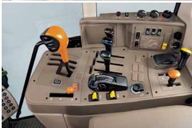
Przekładnia AutoQuad Plus wywodzi się z przekładni PowrQuad Plus. Można ją poznać po dodatkowym przycisku na drążku zmiany zakresów przekładni z napisem AUTO.
