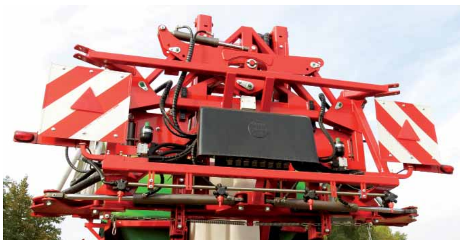
Za stabilizację belki polowej odpowiada mieszany układ wahadłowo-trapezowy.
