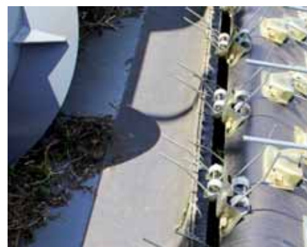
Znajdujący się za taśmą podbieracza fartuch chroni przed zaciągnięciem materiału z powrotem przez palce na ściernisko.
