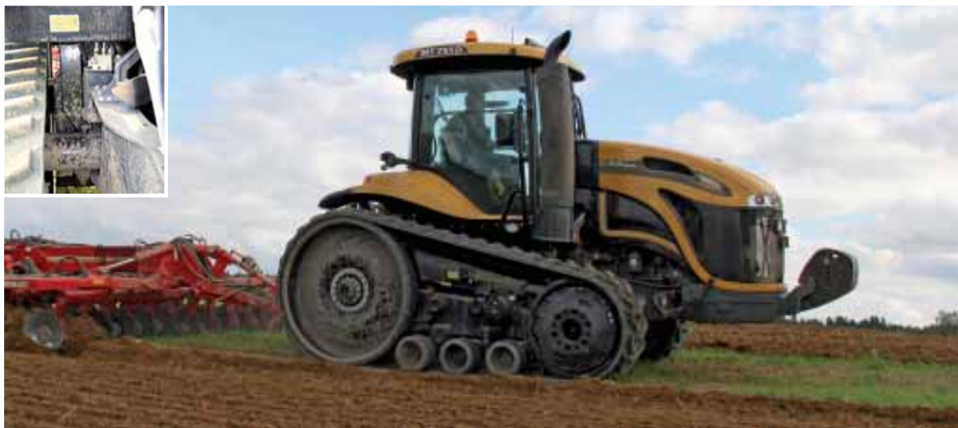
Układ jezdny ciągników Challenger wyposażony jest w amortyzację.
