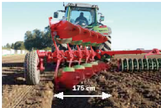
Ibis Vario 5 rozstawiony na maksymalną szerokość odwraca pas gleby o szerokości 2,5 m, a na minimalną 1,75 m.
