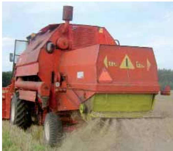
Jeden z dwóch Gigantów, obecnych aktualnie w gospodarstwie w Karsince, ma zainstalowaną siewkarnię od kombajnu Claas Dominator 108, która przyjęła się znakomicie.
