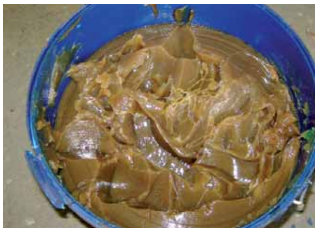
Smar plastyczny to substancja o konsystencji od płynnej do stałej, której podstawowymi składnikami są faza ciekła i zagęszczacz (tzw. substancja żelująca).
