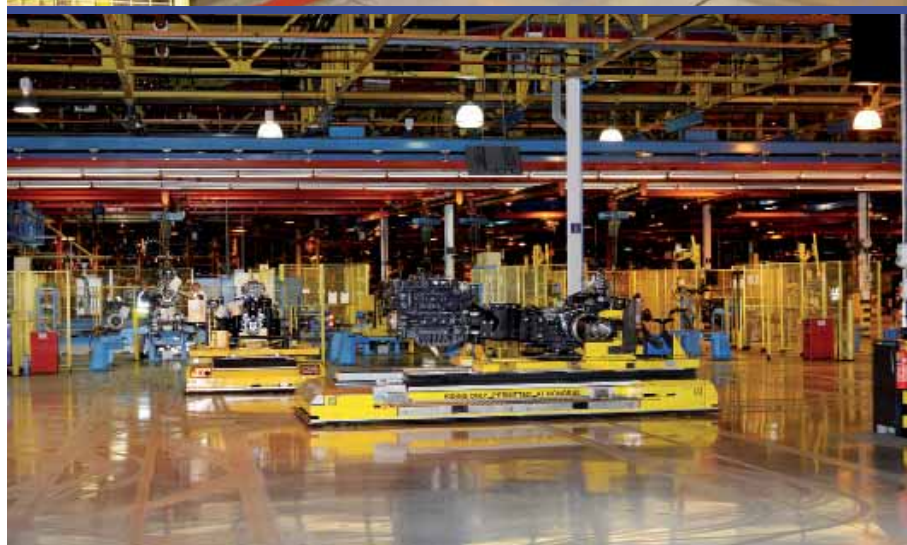
Pojazdy AGV (Auto Guided Vehicle) bez udziału ludzi przewożą silniki oraz przekładnie napędowe do miejsc montażu.
