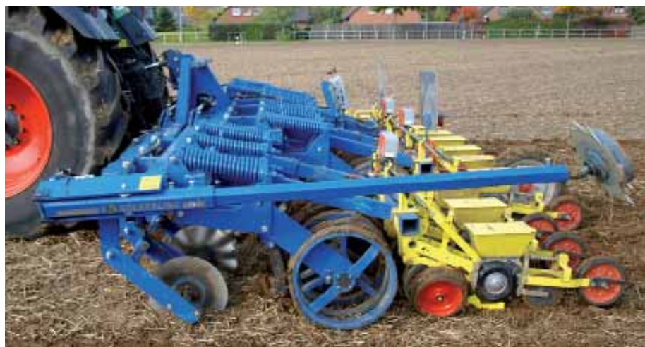
Agregat uprawowo-siewny Bito Plus firmy Köckerling do jednoczesnej uprawy gleby i siewu punktowego buraków cukrowych.
