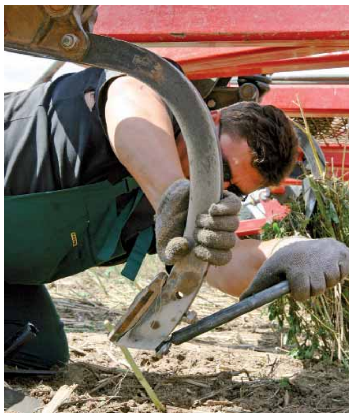
Aby rzadziej wymieniać elementy robocze narzędzi uprawowych, można pokryć je warstwą trudnościeralnego stopu.
