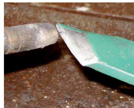
Po ustawieniu parametrów napawanie rozpoczynamy od dolnej krawędzi redliczki.
