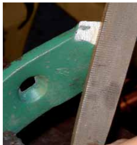
Nową redliczkę przed napawaniem należy dokładnie oczyścić pilnikiem.
